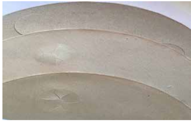
Рис. 8. Візуалізація лабораторних зразків картону, отриманих із волокнистих напівфабрикатів павловнії
